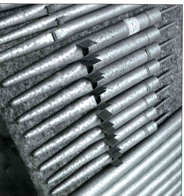
Acht pijpen van de Rohr Flöte 8'. Let op de opsnede en de grote zijbarden.
