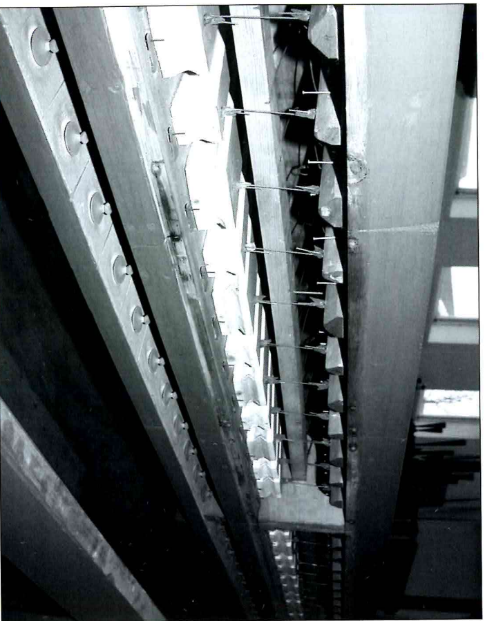
Pedalblade met weggenomen voorlagen. Membranen, pistons en ventielen zijn goed zichtbaar.
