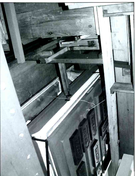
De herstellde magazijnbalg met de originele gietijzeren gewichten.
