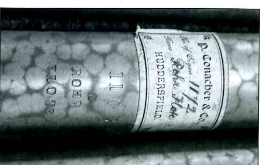
In het pijpwerk zijn de registernaam, de toonhoogte en het opusnummer gestempeld. Hier is ook het label van de firma Conacher met het opusnummer en de registernaam zichtbaar.
